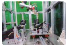
Verschraubung in Leuchteneinheiten
